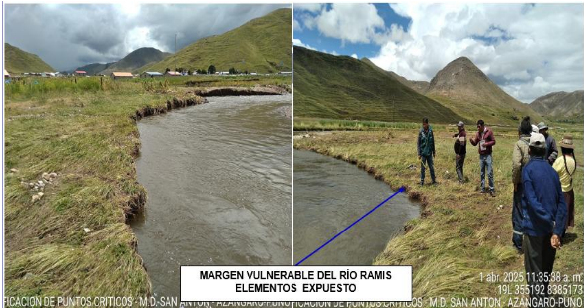
FIGURA N°01: TRAMO CRÍTICO EN EL RÍO RAMIS, DONDE SE EVIDENCIA LA EROSION DE LA RIBERA DEL RIO EN EL SECTOR HUANACOMAYO, DISTRITO DE SAN ANTON, PROVINCIA DE AZANGARO - PUNO.
